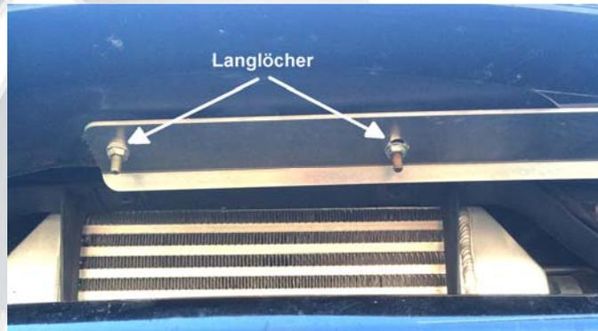
Mit den in Halterung befindlichen Langlöchern wird die Halterung entsprechend der Stoßstange ausgerichtet. Lassen Sie genug Platz zwischen der Halterung und der Stoßstange, so das es hier nicht zu Lackschäden kommt. Im Lieferumfang enthalten sind alle benötigten Schrauben.
